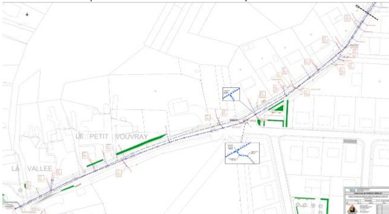
Le délégataire a procédé au renouvellement d'une conduite DN 125 Fonte Grise Rue de Fontenaille à Rochecorbon par 125 ml de fonte ductile DN 125 mm et 95 ml de PVC DN 63 mm.
